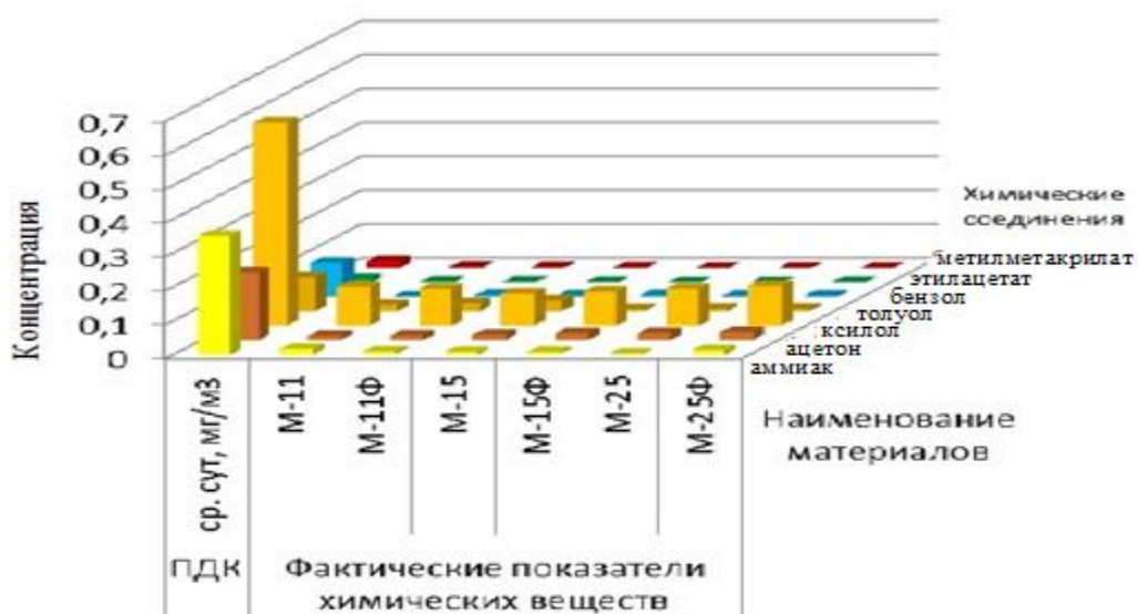
Рисунок 4 – Результаты анализа объемов выделения продуктов деструкции образцов матов из штапельного стекловолокна
